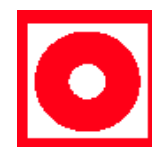
Pulsador de aviso de alarma
